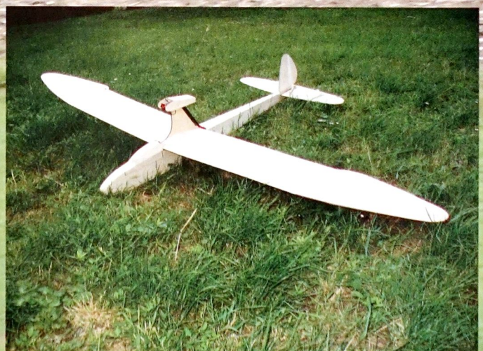
Das Modell des Albatros im Rohbau vor dem Lackieren.
